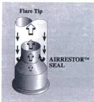
รูปที่ 2-15 ตัวอย่าง Velocity Seal
