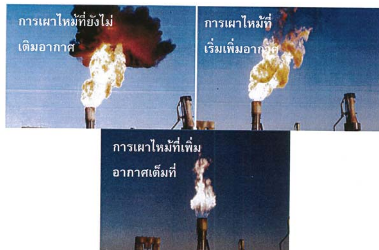
รูปที่ 5-12 การเปรียบเทียบของการเผาไหม้เมื่อใช้อากาศช่วยเพื่อการเผาไหม้
