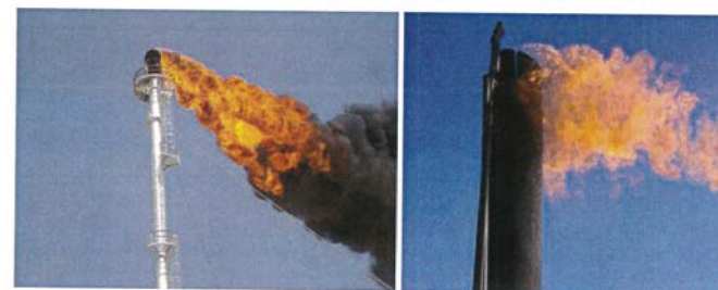
รูปที่ 4-10 ตัวอย่างกรณีเกิด Flame Pull-down
