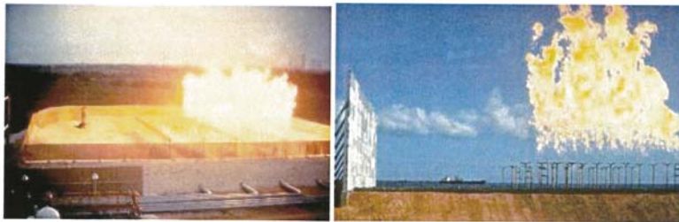
รูปที่ 2-3 ตัวอย่าง Opened Ground Flare
